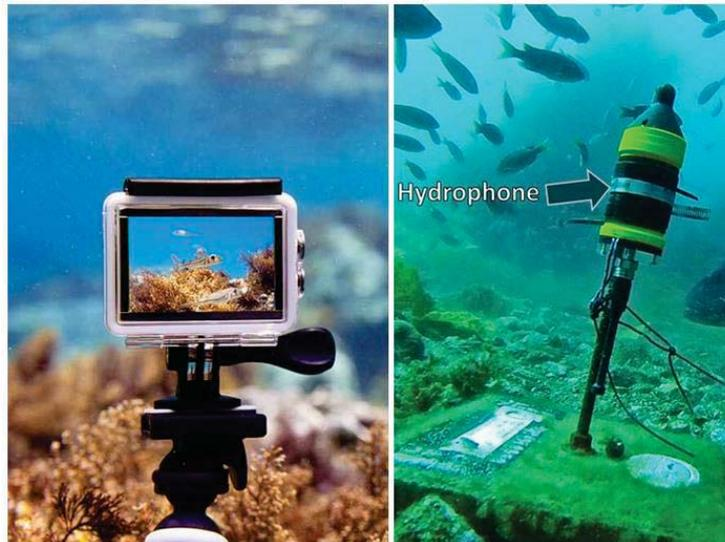
**Figura 2.** Ejemplos de fondeo de sensores por separado: videocámara grabando peces (izquierda) e hidrófono grabando sonidos de peces (derecha). Imágenes [https://www.123rf.com/photo\\_167342976\\_using-action-camera-in-waterproof-box-on-a-flexible-foldable-mini-tripod-to-make-photos-and-video.html](https://www.123rf.com/photo_167342976_using-action-camera-in-waterproof-box-on-a-flexible-foldable-mini-tripod-to-make-photos-and-video.html); <https://www.oceaninstruments.co.nz/>
